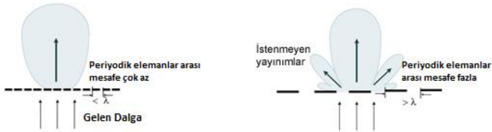
Şekil 12 : Periyodik bir yüzeye gelen düzlemsel dalga ve istenmeyen yayınımların meydana gelişini (MUNK, 2000).
