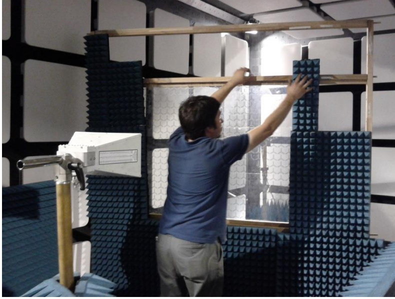
Şekil 28 : Yansısız odada ölçüm düzeneğinin hazırlanması
