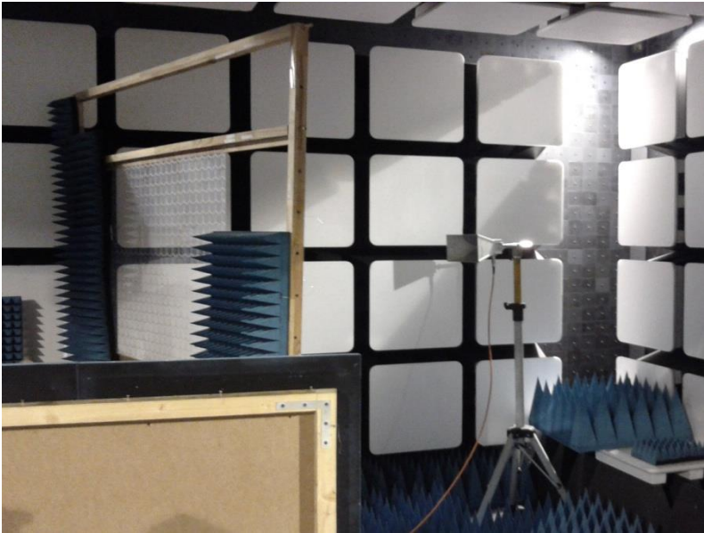
Şekil 29 : Yansısız odada ölçüm düzeneğinin hazırlanması
