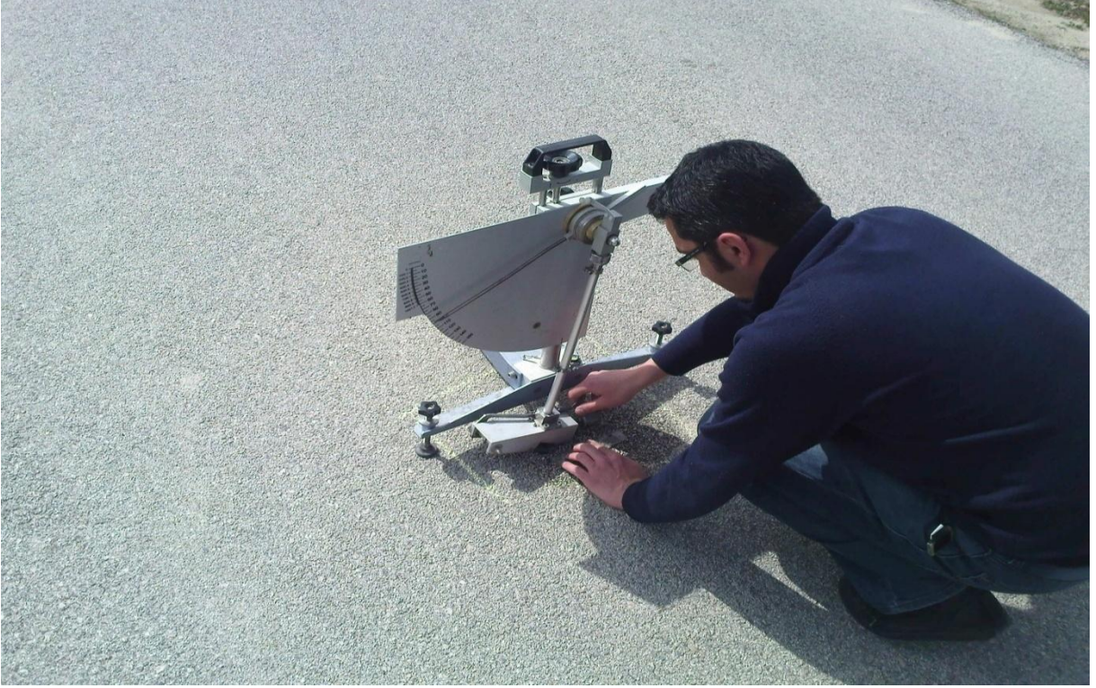
Şekil 8.10. Pandül ile asfalt betonu sürtünme ölçümlerinin gerçekleştirilmesi.
