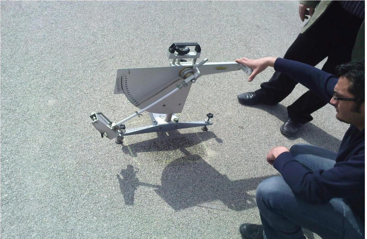
Şekil 8.11. Pandül ile asfalt betonu sürtünme ölçümlerinin gerçekleştirilmesi
